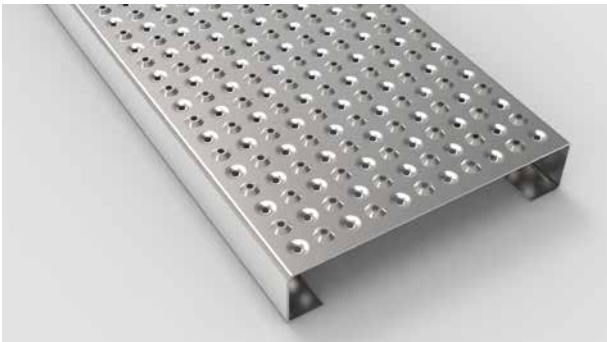
Type AP 2 - 30 veiligheid met afwatering (VMA) Antislipperforatie Ø 5 mm, h.o.h. 30 mm, hoog 3 mm. Afwateringsperforatie Ø 5 mm, h.o.h. 30 mm, diep 3 mm.
