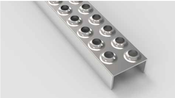
Type AP 2 - 50 laddersport (LAD2) Antislipperforatie Ø 12 mm, h.o.h. 25 mm, hoog 5 mm Breed 50 mm, hoogte zetting 37 mm.
