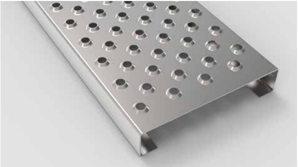
Type AP 2 - 40 zonder afwatering (ZAW) Type AP 3 - 40 zonder afwatering (ZAW) Antislipperforatie Ø 14 mm, h.o.h. 40 mm, hoog 4 mm. Geen afwateringsperforatie.
