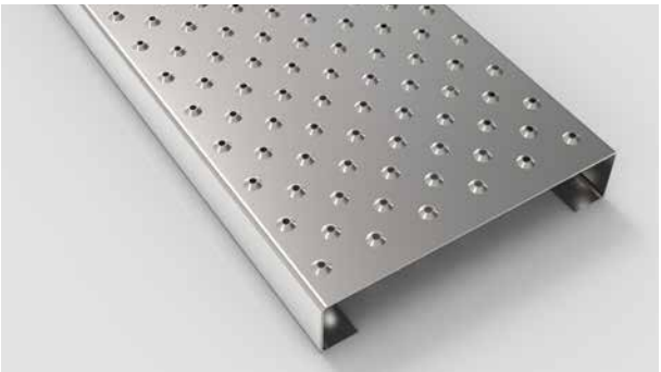
Type AP 2 - 30 veiligheid zonder afwatering (VZA) Antislipperforatie Ø 5 mm, h.o.h. 30 mm, hoog 3 mm. Geen afwateringsperforatie.
