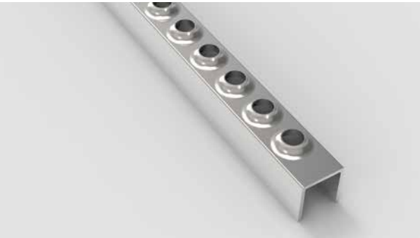
Type AP 2 - 50 laddersport (LAD1) Antislipperforatie Ø 12 mm, h.o.h. 25 mm, hoog 5 mm Breed 25 mm, hoogte zetting 37 mm.
