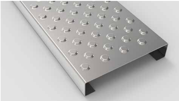
Type AP 2 - 40 gesloten (NOP) Type AP 3 - 40 gesloten (NOP) Perforatie Ø 14 mm dicht doorgedrukt h.o.h. 40 mm, hoog 4mm. Geen afwateringsperforatie.
