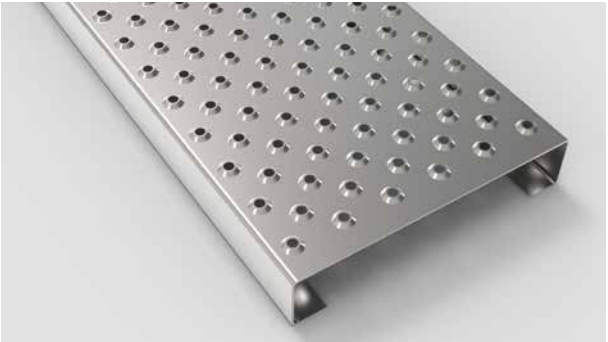
Type AP 2 - 30 sans drainage (ZAW) Perforation antidérapante Ø 8 mm poinçonnée vers le haut à 3 mm de hauteur sur un espacement de 30 mm c.t.c. en quinconce. Pas de perforation de drainage.
