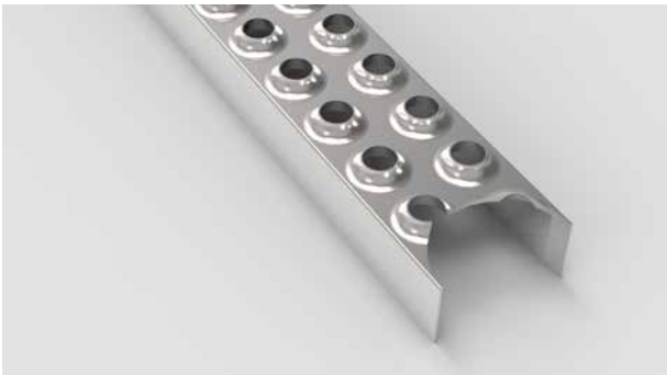
Type AP 2 - 50 échelons (LAD2) avec encoche, à 48,3 mm Avec évidement, à 48,3 mm Perforation antidérapante Ø 12 mm, c.t.c. 25 mm, hauteur 5 mm. Largeur 50 mm, réglage en hauteur 37 mm.
