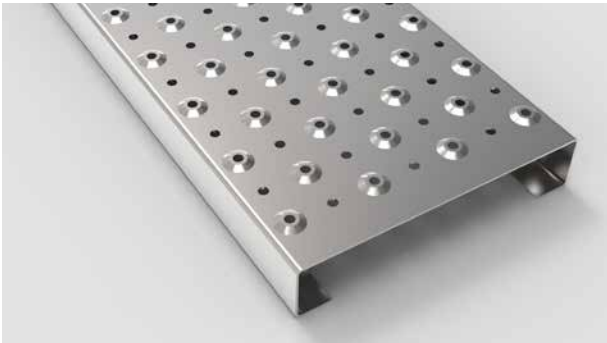
Type AP 2 - 50 avec drainage (MAA) Type AP 3 - 50 avec drainage (MAA) Dôme gaufré avec perforation Ø 8 mm sur 3 mm de hauteur. Perforation de drainage plate de Ø 8 mm, toutes deux en quinconce de 50 mm c.t.c.
