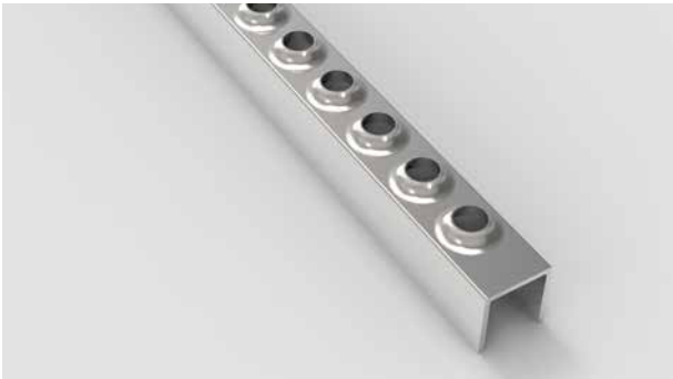
Type AP 2 - 50 échelon d'échelle (LAD1) Perforation antidérapante Ø 12 mm, c.t.c. 25 mm, 5 mm de hauteur. Largeur 25 mm, réglage de la hauteur 37 mm.
