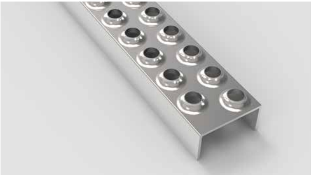
Type AP 2 - 50 échelons (LAD2) Perforation antidérapante Ø 12 mm, entraxe 25 mm, hauteur 5 mm. Largeur 50 mm, hauteur 37 mm.
