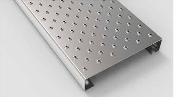
Type AP 2 - 30 sécurité sans drainage (VZA) Perforation antidérapante Ø 5 mm poinçonnée vers le haut à 3 mm de hauteur sur un pas de 30 mm c.t.c. en quinconce. Pas de perforation de drainage.
