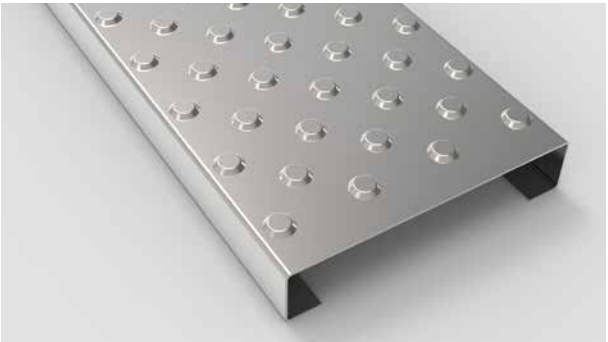
Type AP 2 - 50 fermé (NOP) Type AP 3 - 50 fermé (NOP) Dôme gaufré Ø 16 mm d'une hauteur de 4 mm sur un motif en quinconce de 50 mm. Également disponible avec une perforation de drainage de Ø 8 mm si nécessaire.
