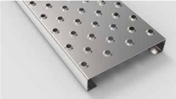
Typ AP 2 - 50 ohne Drainage (ZAW) Typ AP 3 - 50 ohne Drainage (ZAW) Rutschhemmende Perforation Ø 14 mm, 4 mm hoch gestanzt, im Raster von 50 mm versetzt. Keine Drainagelöcher.
