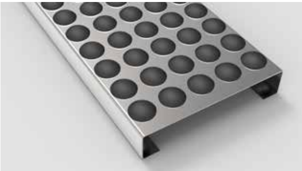
Typ AP 2 - 50 Gummikappen (DOP) Typ AP 3 - 50 Gummikappen (DOP) Perforation Ø 14 mm, Querschnitt 50 mm, 4 mm tief, auf Wunsch auch mit Drainagelochung Ø 8 mm, Querschnitt 50 mm, 0 mm tief. Geeignet für die Verwendung von Gummikappen. Bevorzugte Breiten in Vielfachen von 50 mm.
