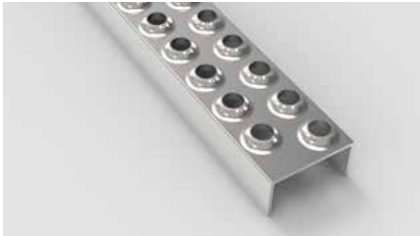
Typ AP 2 - 50 Leitersprossen (LAD2) Anti-Rutsch-Lochung Ø 12 mm, Querschnitt 25 mm, 5 mm hoch. Breite 50 mm, Höheneinstellung 37 mm.
