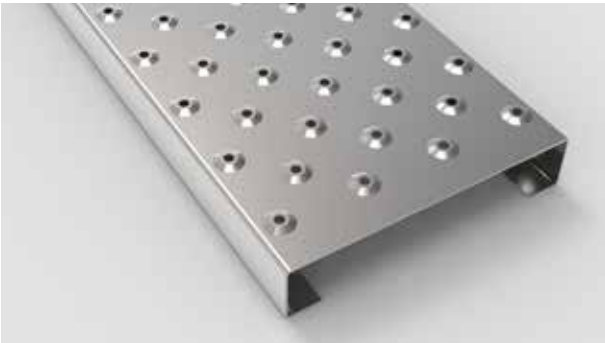
Typ AP 2 - 50 ohne Drainage (ZAA) Typ AP 3 - 50 ohne Drainage (ZAA) Geprägte Kuppel mit Ø 8 mm Perforation, 3 mm hoch gestanzt. Keine Drainagelöcher.
