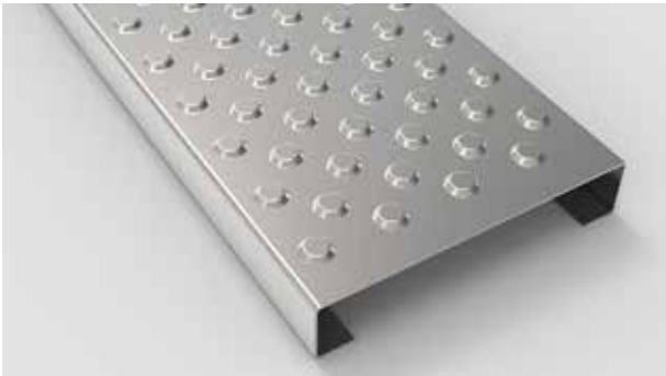
Typ AP 2 - 40 geschlossen (NOP) Typ AP 3 - 40 geschlossen (NOP) Geprägte Ø 14 mm Kuppel 4 mm hoch auf einem 40 mm versetzten Raster. Keine Drainagelöcher.
