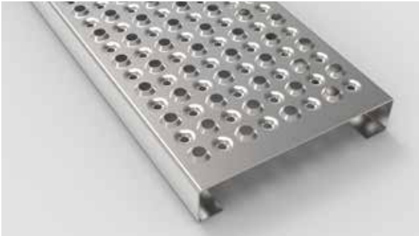
Typ AP 2 - 40 mit Drainage (MAW) Typ AP 3 - 40 mit Drainage (MAW) Antirutsch-Lochung Ø 14 mm oben 4 mm hoch gestanzt. Drainagelochung Ø 8 mm, unten 2 mm tief gestanzt, beide im Raster von 40 mm versetzt.
