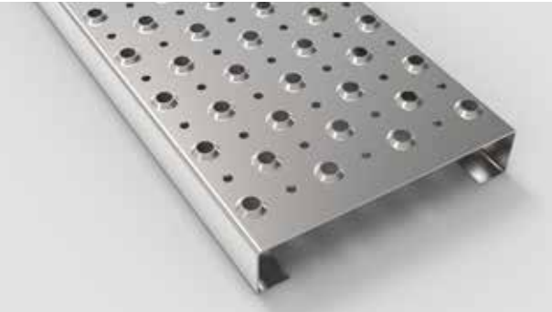
Typ AP 2 - 50 mit Drainage (MAW) Typ AP 3 - 50 mit Drainage (MAW) Rutschhemmende Perforation Ø 14 mm, 4 mm hoch gestanzt. Drainagelochung flach Ø 8 mm, beide im Raster von 50 mm gegeneinander versetzt.
