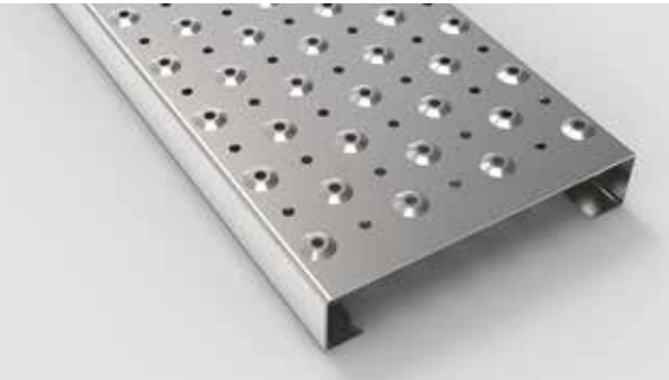
Typ AP 2 - 50 mit Drainage (MAA) Typ AP 3 - 50 mit Drainage (MAA) Geprägter Dom mit Ø 8 mm Perforation, 3 mm hoch gestanzt. Drainagelochung flach Ø 8 mm, beide im Raster von 50 mm versetzt.
