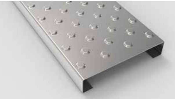
Typ AP 2 - 50 geschlossen (NOP) Typ AP 3 - 50 geschlossen (NOP) Geprägter Dom Ø 16 mm, 4 mm hoch, auf 50 mm versetztem Muster. Auf Wunsch auch mit Drainagelochung Ø 8 mm erhältlich.
