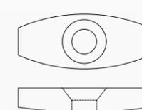
Les kits de fixation Staco pour panneau dentelés comprennent un disque spécial à utiliser comme élément de fixation supérieur. Disponible en plastique ou en acier (galvanisé selon EN-ISO 1461).
