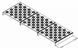
Les panneaux qui doivent supporter la charge doivent être soutenus aux deux extrémités.
