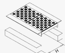
Les dimensions intérieures nettes, entre les profils de montage, ou les dimensions nettes de l'évidement. La taille du panneau doit être inférieure à la taille du trou ou à la largeur libre.
