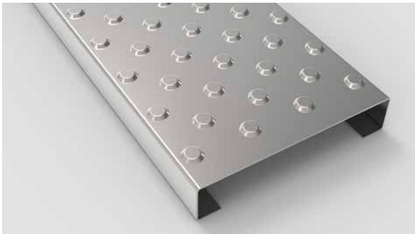
Type AP 2 - 50 gesloten (NOP) Type AP 3 - 50 gesloten (NOP) Antislipperforatie Ø 16 mm dicht doorgedrukt h.o.h. 50 mm, hoog 4 mm. Eventueel met vlakke afwateringsperforatie Ø 8 mm, h.o.h. 50 mm.
