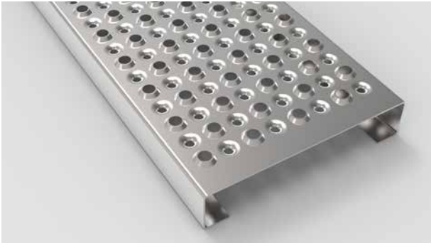
Type AP 2 - 40 met afwatering (MAW) Type AP 3 - 40 met afwatering (MAW) Antislipperforatie Ø 14 mm, h.o.h. 40 mm, hoog 4 mm. Afwateringsperforatie Ø 8 mm h.o.h. 40 mm, diep 2 mm.
